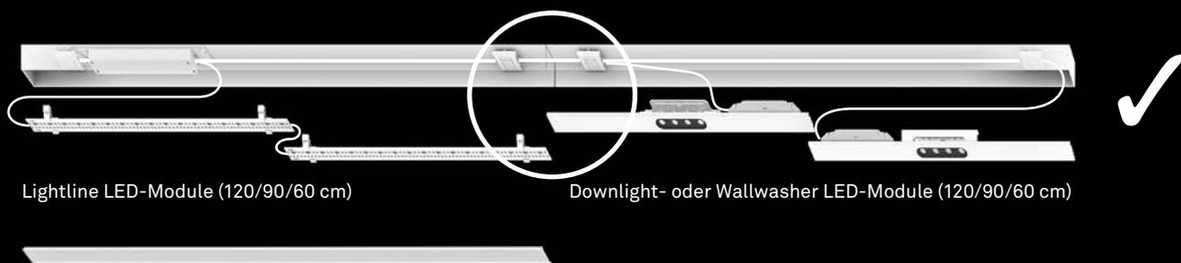
Downlight- oder Wallwasher LED-Module dürfen nicht beim Übergang der Tragschienen platziert werden!
