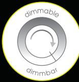
Es handelt sich um eine dimmbare Leuchte. Das Dimmen erfolgt entweder über einen Dreh- oder Tastdimmer an der Leuchte oder über einen externen Phasenabschnittdimmer.
